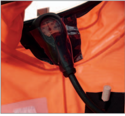
Soporte para el manómetro o Bodyguard situado en el campo de visión del usuario.
